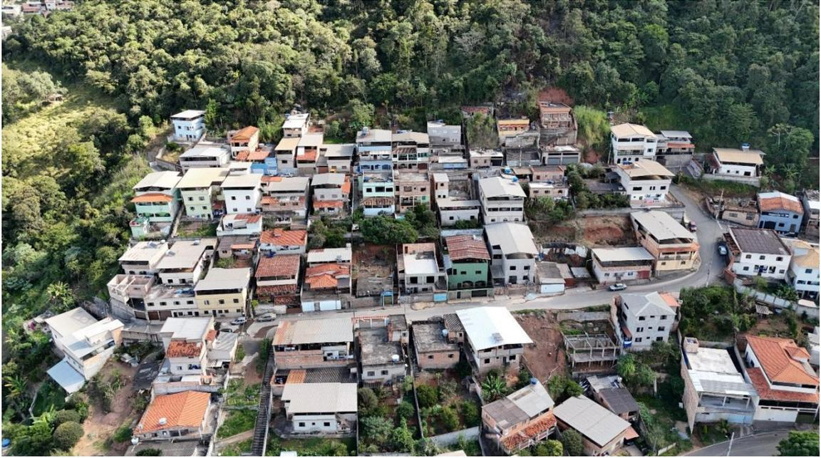
Foto 5 - Registro Fotográfico por drone no Bairro Novo Horizonte onde se observa micro movimento de massa ou solo exposto ao fundo de lotes com edificações residenciais.
