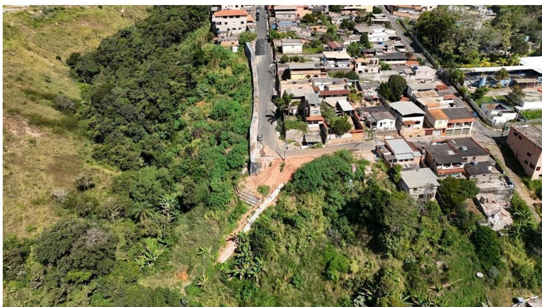
Foto 8 – Registro fotográfico por drone no bairro Santa Rita, evidenciando, à esquerda da imagem, a área da grotas onde ocorreu remoção de edificações residenciais, implantação de obras de contenção geotécnica e sistema de drenagem superficial.
